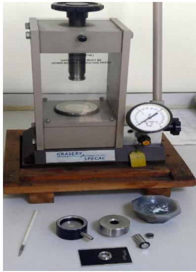
الشكل 15. II: (a) صورة لجهاز FTIR (b) صورة لادوات المستعملة لتحضير العينة
