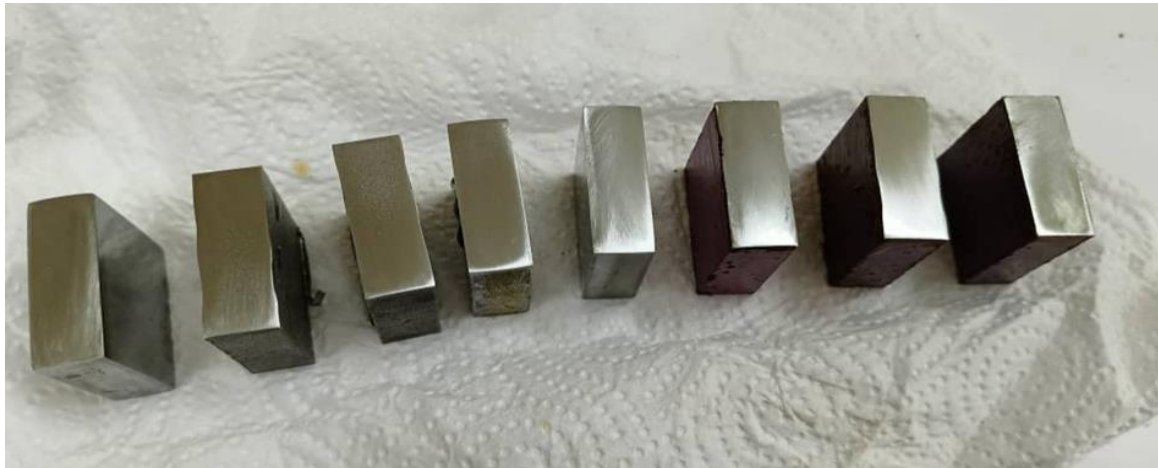
الشكل (II-4): عينات الفولاذ بعد الصقل.
