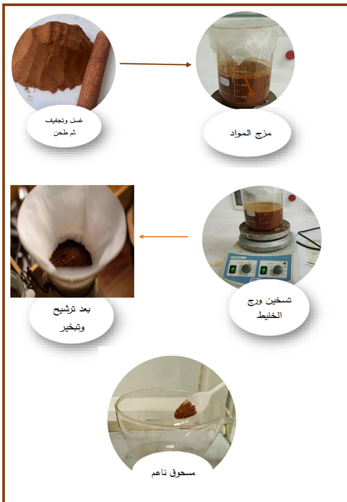
الشكل (II-5): مخطط يوضح خطوات العمل لتحضير المستخلص المائي للقرفة.
