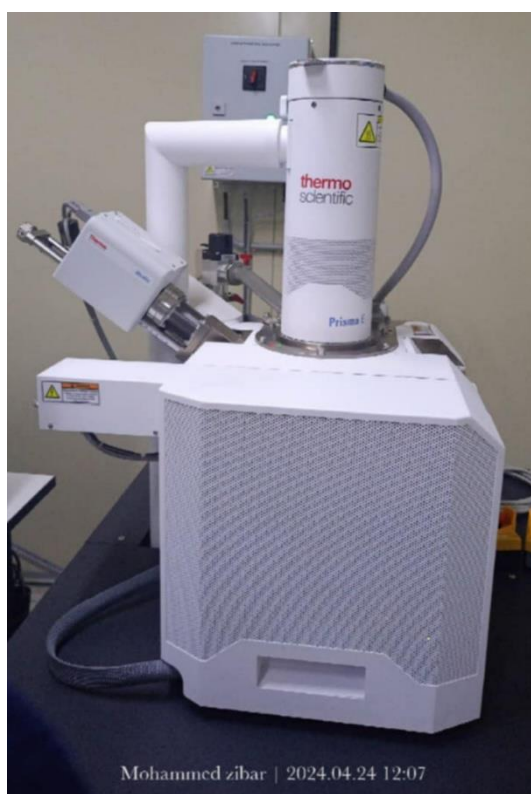
الشكل (II-8): جهاز المجهر الإلكتروني الماسح.
