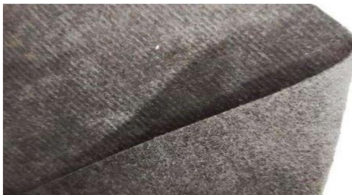
الشكل (1. 7) الكربون المنشط المغلف بالبوليمرات (PCAC). [27]
