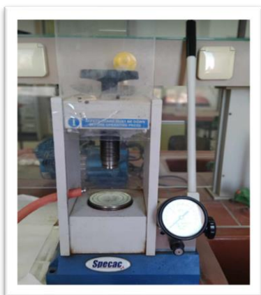
الشكل (15.ii) وضع المسحوق في جهاز ضغط يدوي هيدروليكي من Specac
