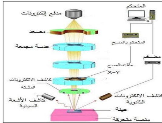
الشكل 9.II رسم تخطيطي يوضح مبدأ عمل المجهر الإلكتروني الماسح [11].
