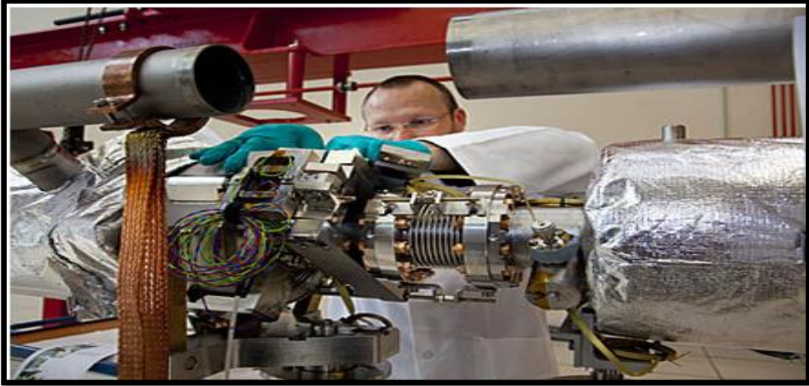
الشكل (1. III) مسرع خطي الكترون © P.Dumas /CEA XFEL لإنتاج أشعة السينية.
