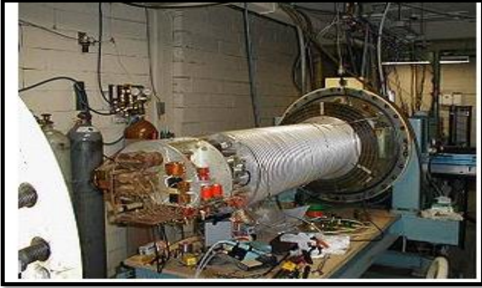
الشكل (12. II) معجل فان دي غراف بقوة 2(MV) ميجا فولت يعود تاريخه
