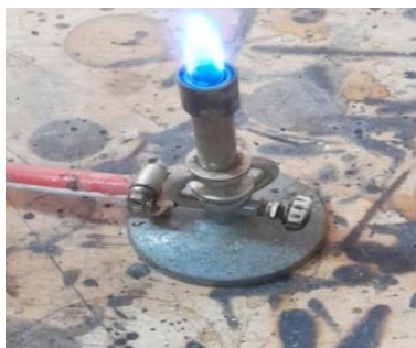
الشكل (5.II): صورة فوتوغرافية لموقد بنزن.
