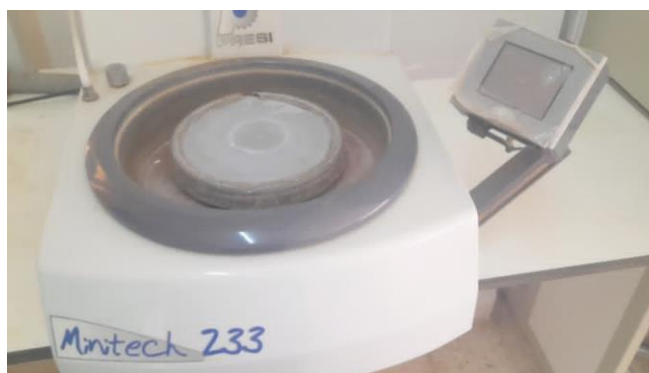
الشكل (9.II): صورة فوتوغرافية للآلة الصقل.
