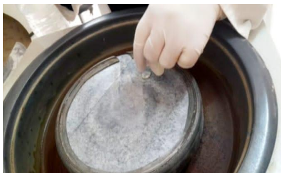
الشكل (14.II): صورة فوتوغرافية لعملية صقل العينة الزجاجية.
