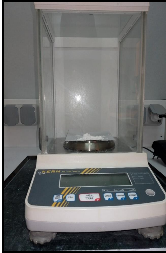
الشكل (II. 5) صورة فوتوغرافية لميزان الدقة من نوع KERN
