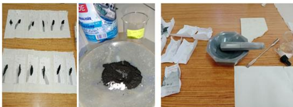
Figure 2.11 : L'ajout d'un agent moussant (agent porogène).
