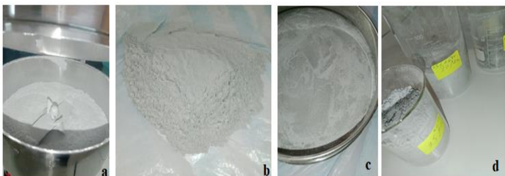
Figure 2.9 : Etapes de préparation de la matière première (poudre de verre).
