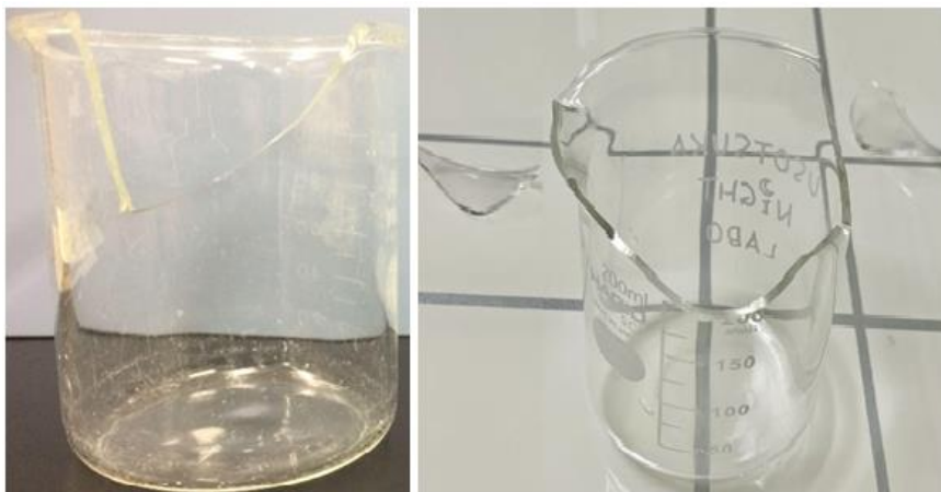
Figure 2.1 : béchers en verre endommagés.
