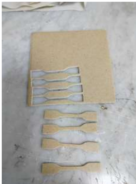
Figure II.12 : Géométries d'éprouvettes de traction.
