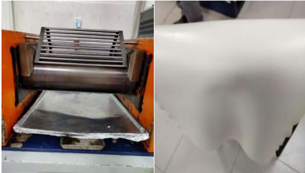
Figure II.6 : Calandrage du mélange de PVC et de poudre de feuilles de palmier.
