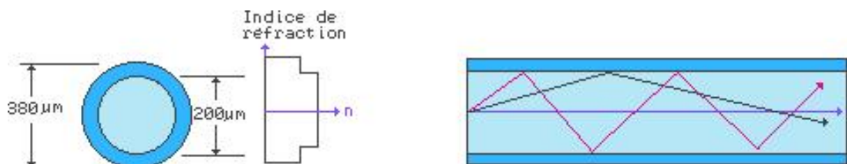
Figure I.3: Fibre multimodes à saut d'indice Réf [7].
