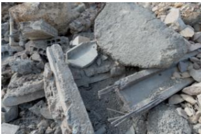
Figure 9.1 : déchets du béton démoli
