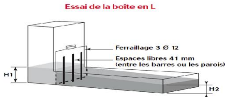
Figure 3.5 : boîte en L pour essai du taux de remplissage
