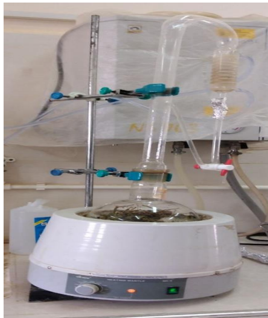
Figure 4. Montage de l'extraction par hydrodistillation. (Photo originale, 2025).
