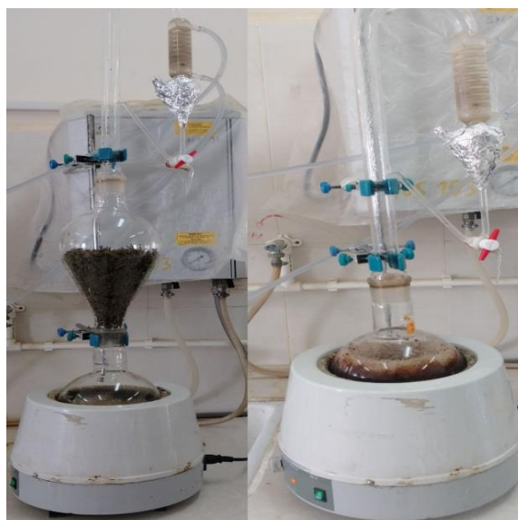
Figure 3 . Montage de l'hydrodistillation (Appareil de type Clevenger).
