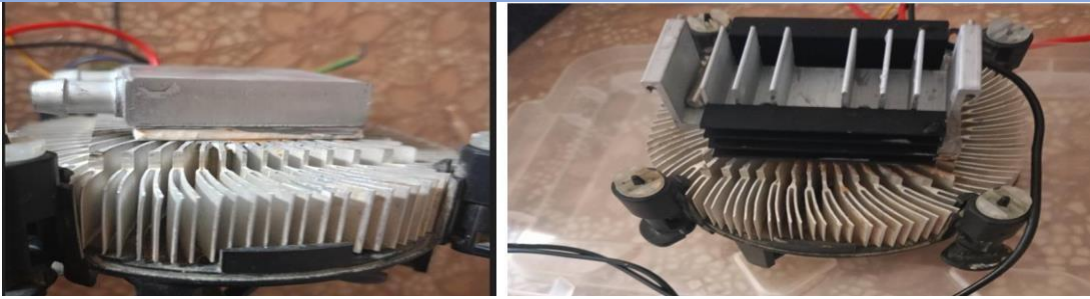
Figure IV.2 : Les différents dissipateurs thermiques utilisés sur le module Peltier (Zouita.2024).
