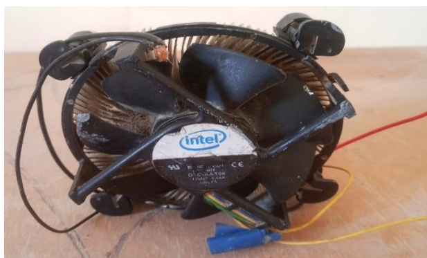
Figure IV.7 : Ventilateur 12V 0,15A.
