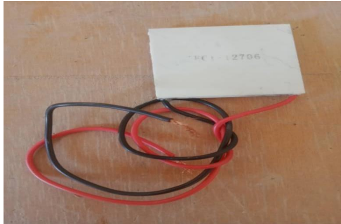
Figure IV.5 : Module refroidissement thermoélectrique à effet Peltier TEC1-12706 12V 6A.
