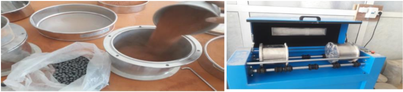
Figure1. 19: Granulés de brique dans le Moule de la machine de Micro Duval avec granulés de fer
