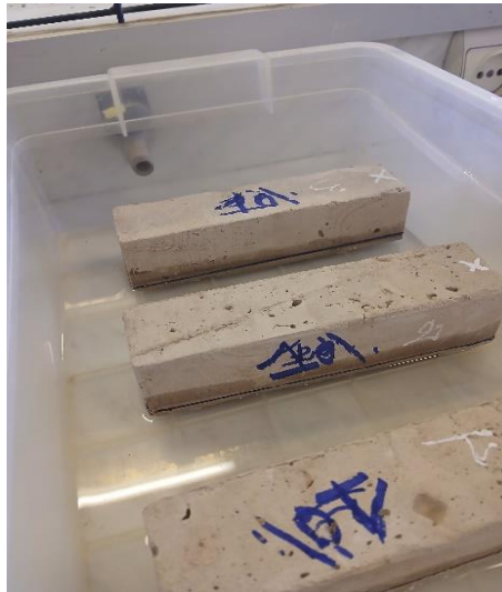
Figure2. 15: Essai d'absorption par capillaire.
