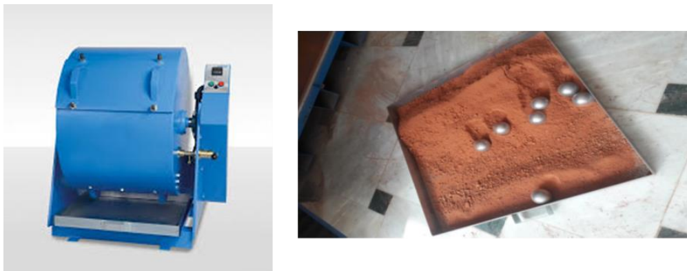
Figure1. 18 : Les granules des briques que nous avons obtenus De la machine los Anglos
