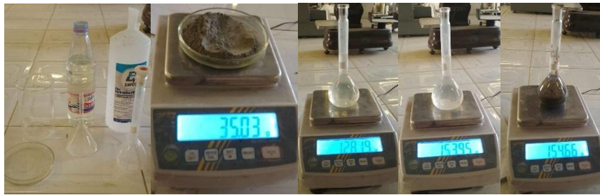
Photo II.9: Les étapes d'essai de la masse volumique absolue.
