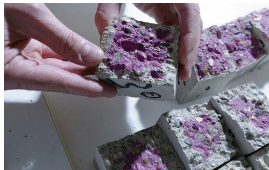
Figure I 13 : Influence de la carbonatation sur le béton à base des granulats recyclés. [37]
