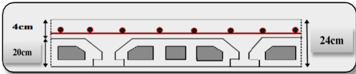
Figure II-1 : Coupe verticale du plancher en corps creux
