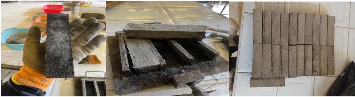
Figure II.21 : Démoulage des éprouvettes
