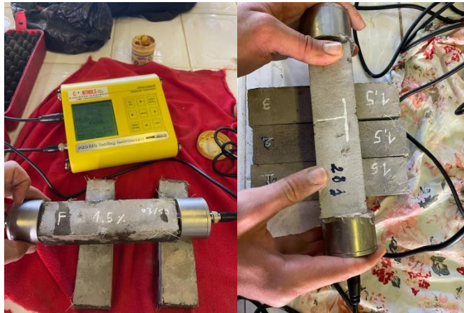
Figure II.26 : Essai par ultrasons
