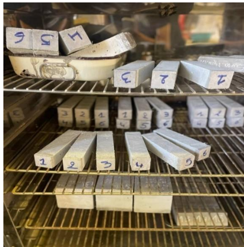
Figure II.23 : les éprouvettes à l'intérieur de l'étuve
