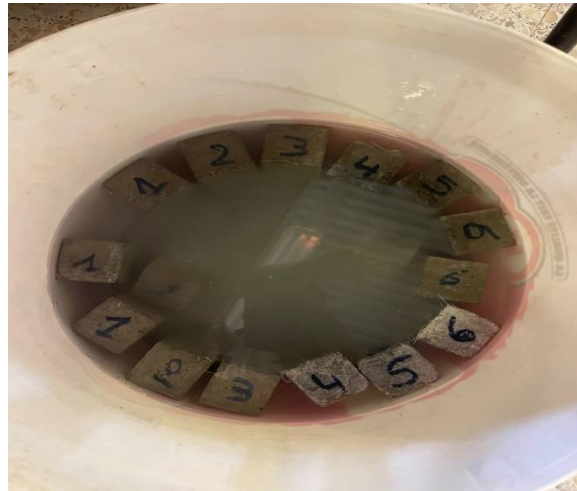
Figure II.25 : Essai d'absorption d'eau par immersion
