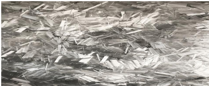
Figure I.11 : fibre de verre [28].
