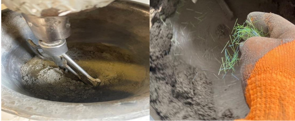
Figure II.16 : Malaxeur électrique utilisée dans la fabrication du mortier
