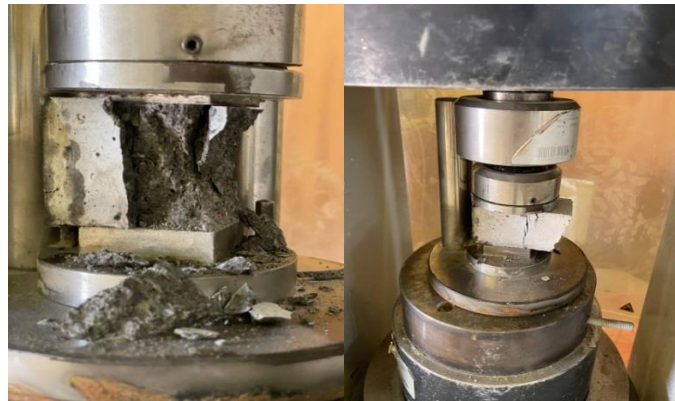
Figure II.28 : Essai de compression réalisé sur les éprouvettes (4 x 4 x 16) cm
