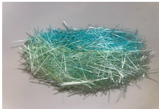
Figure II.13 : Découpage des fibres plastiques extraites des poils de balais
