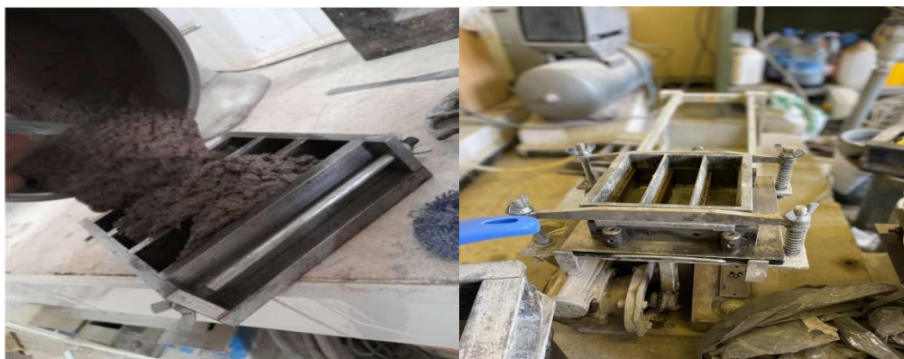
Figure II.19 : Remplir le moule et le mettre dans l'appareil à chocs
