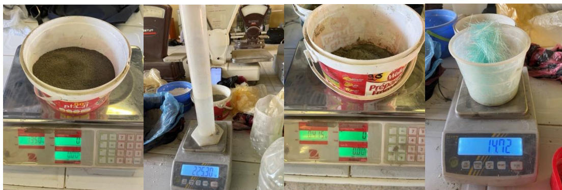
Figure II.15 : Pesage des composants du mortier
