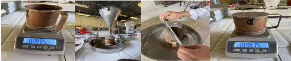
Figure II.3 : Test pour déterminer la densité apparente en laboratoire
