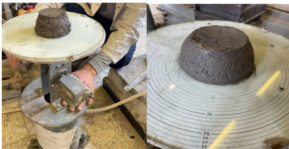
Figure II.20 : Test de l'étalement
