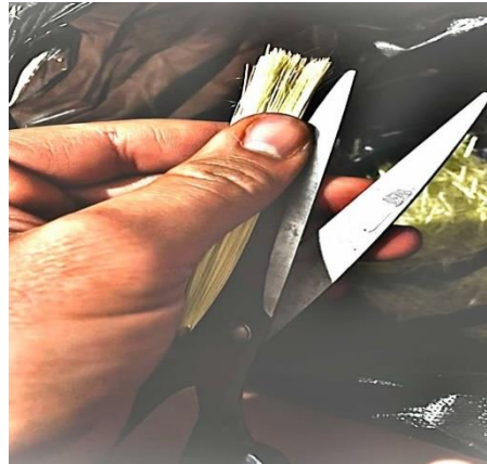
Figure II.13 : Découpage des fibres plastiques extraites des poils de balais
