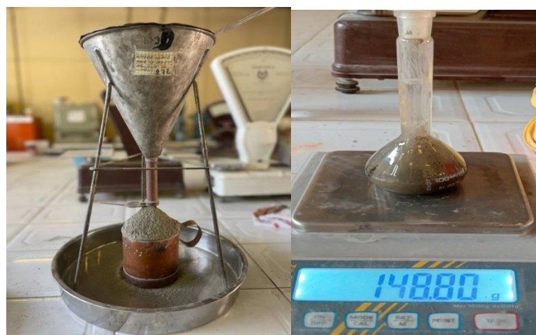
Figure II.12 : La masse volumique de ciment absolue et apparente
