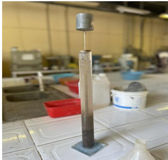
Figure II.7 : Essai d'équivalent de sable carrière
