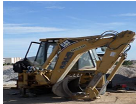
Engin d'excavation (pelle mécanique)
