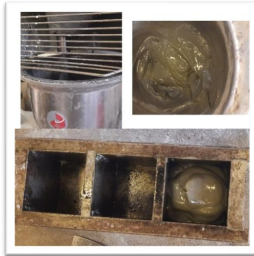
Figure III.15: Malaxage des composants de la pâte de ciment.
