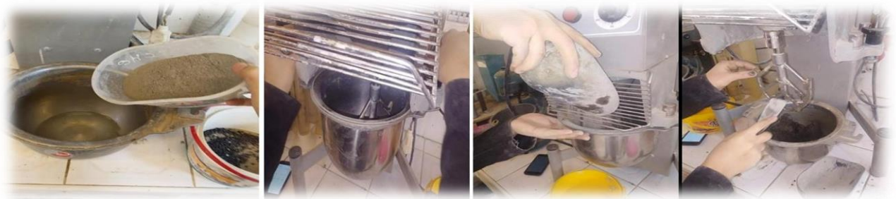
Figure III.20: Malaxage des composants du mortier.
