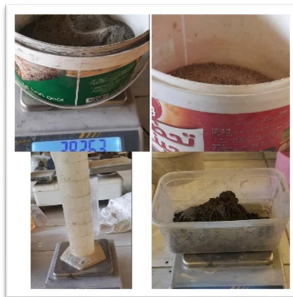
Figure III.18: Pesage des composants du mortier
