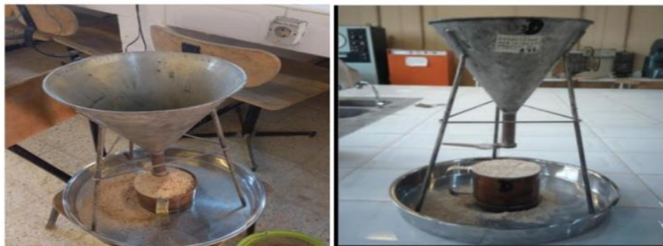
Figure III.4: Essai de la masse volumique apparente du sable d'oued
