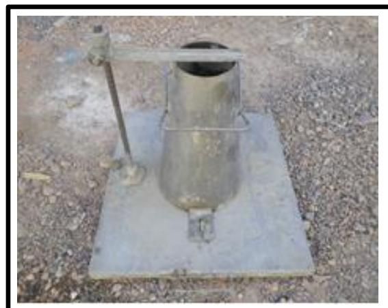
**Figure.1.38.** Le cône d'abrams.
