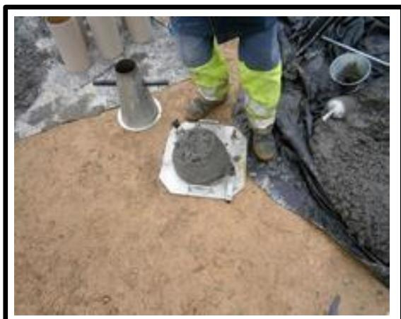
**Figure.1.37.** Après démolage le cône.
