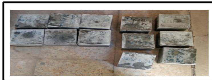
**Figure 1.34.** Des échantillons après démoulage.
