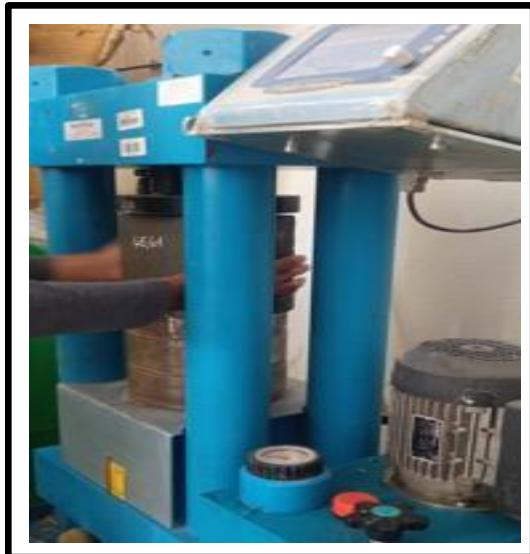
**Figure.1.36.** Mesurer la force de résister à la compression.
