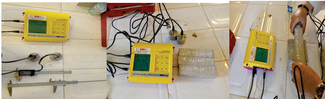
Figure II.18: Essai d'ultrason des éprouvettes (EN 12504-4)
