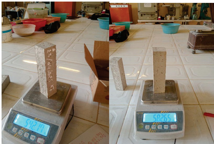
Figure II.17 : la masse volumique sèche d'éprouvette (4*4*16 cm)
