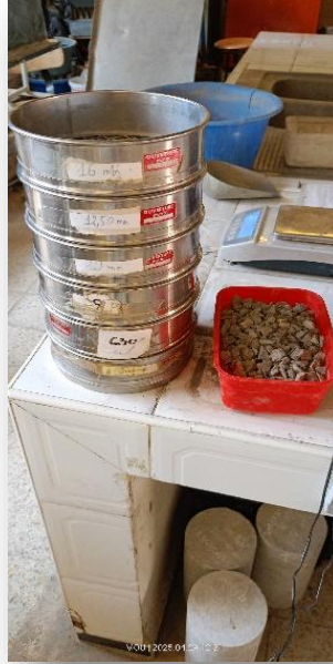
صورة II.14. تجربة التحليل الحبيبي للحصى.
