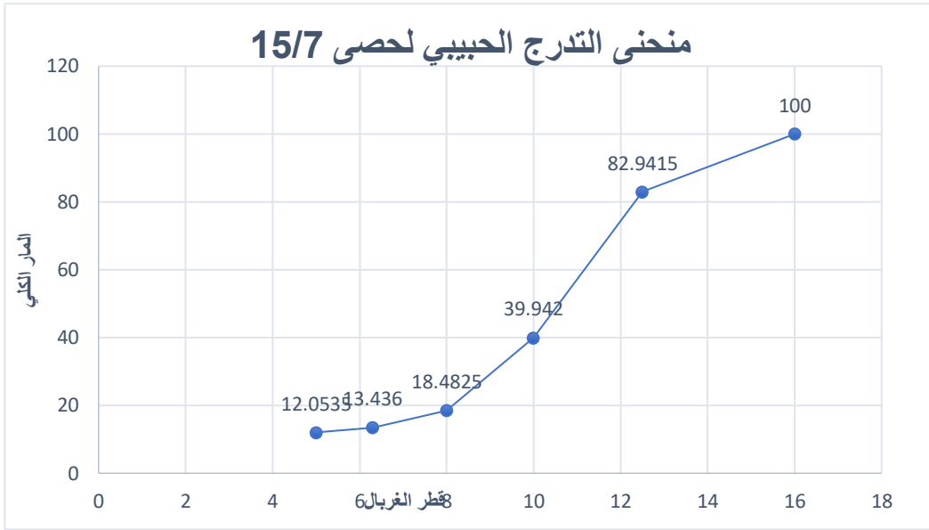
الشكل II.2. منحنى التدرج الحبيبي لحصى (15/7).
