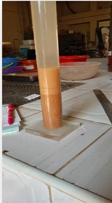
صورة 7. II. تجربة المكافئ الرملي قبل الغسل.
