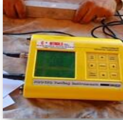
صورة II.22. عملية قياس سرعة الموجات فوق الصوتية في الخرسانة.
