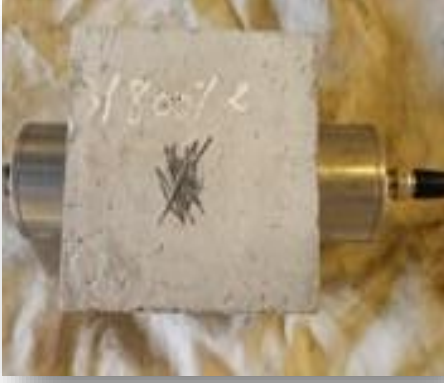
صورة II.22. عملية قياس سرعة الموجات فوق الصوتية في الخرسانة.
