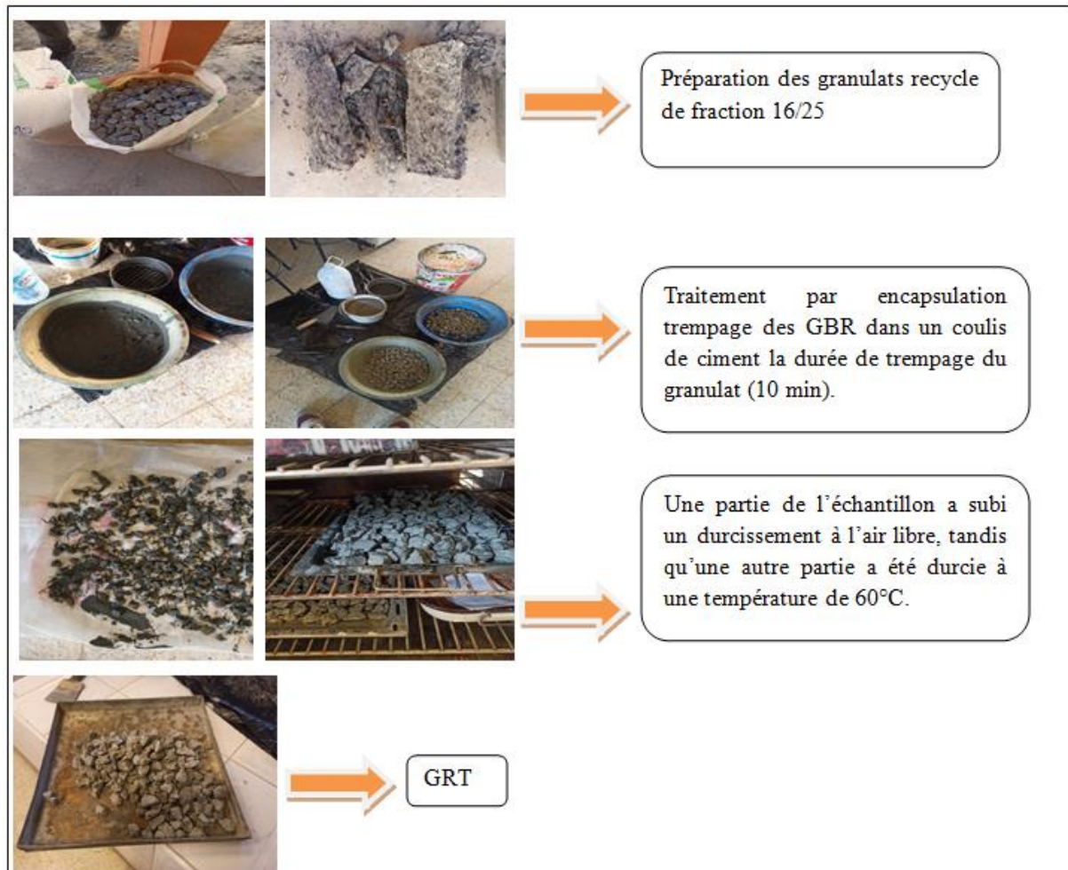
Figure 5. 1: Schéma représentatif du processus d'élaboration et d'encapsulation des GBR.
