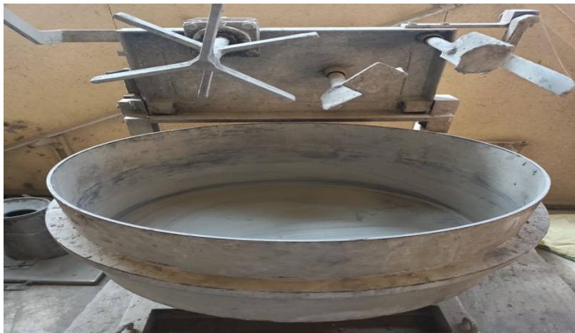
Figure 4. 19: Malaxeur planétaire à axe vertical.
