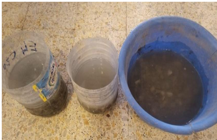
Figure 4. 18: Méthode de pré-saturation des GBR pendant 24 heures.
