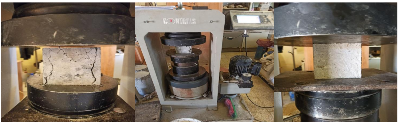
Figure 5. 16: essai de résistance en compression des bétons BGR et BGRT.
