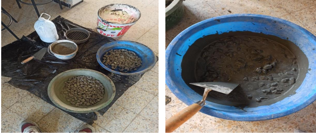
Figure 4. 17: traitement des GBR
