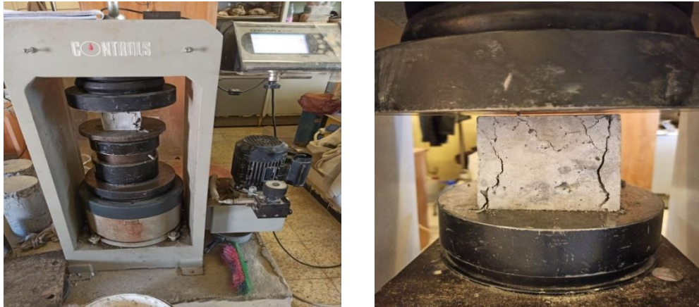
Figure 4. 21: Dispositif pour l'essai des résistances à la compression EN [12390-4].
