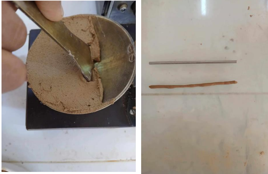
Figure 2. 4Détermination de WL et WP
