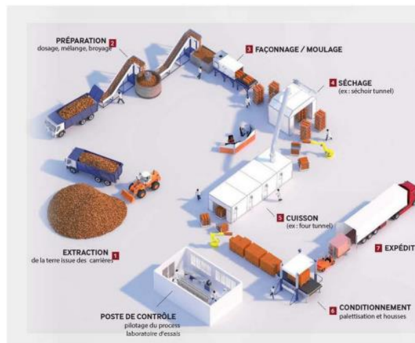
Figure 1. 19 Procédé de fabrication de briques cuites [32]
