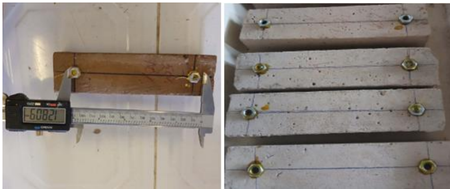
Figure 2. 17 Essai de gonflement
