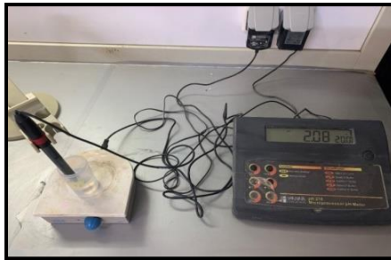
Figure 7 : pH mètre utilisé pour mesurer le pH des échantillons d'eau.
