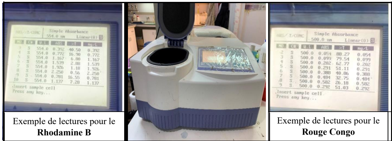
Figure 5 : Spectrophotomètre (Optizen 2120 UV) utilisé pour le dosage du Rhodamine B et du Rouge Congo.
