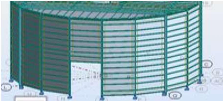
Figure 5.1 : Présentation des éléments porteurs secondaires de la façade
