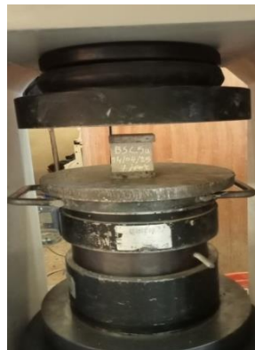
Figure II .6 : Essai de la résistance à la compression.
