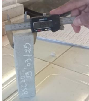
Figure II.9. Mesures des dimensions de l'éprouvette (4x4x16) cm.
