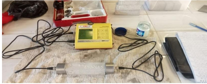
Figure II.8. Instrument de mesure la vitesse du son dans le béton.
