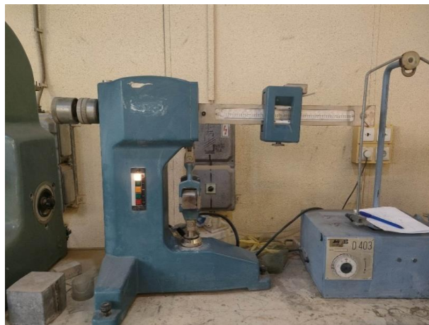
Figure II .7. Essai de la traction par flexion.
