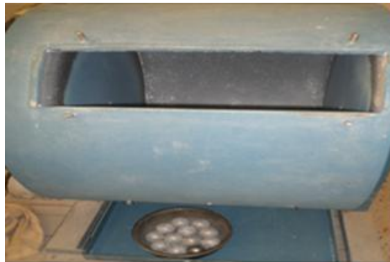
FIGURE 1. 21:Appareil de los Angeles.
