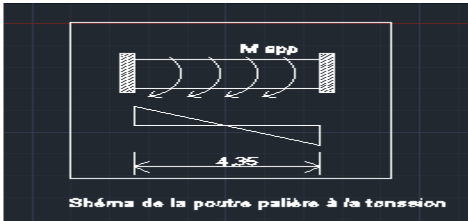
Figure III -11 : schéma de la poutre palière à la torsion
