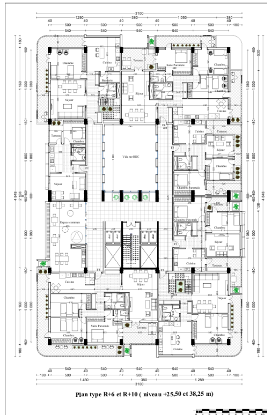
Figure 83: Plan Type de Bloc R+6 et R+10 (+25.50 et +38.25m). Source : Auteur
