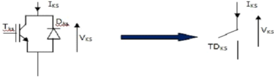
Figure 2.3 – : Interrupteur bidirectionnel équivalent de la paire Transistor – diode
