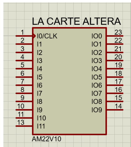
Figure III-3 : Image représentant la carte Altera dans proteus
