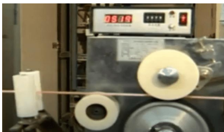
Figure II.8 : Un système de redressement pour éliminer tous les angles ou torsions et appareil de mesure de la longueur.
