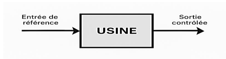
Figure 1.3 : La relation causale entre les intrants et les extrants dans une usine [1]
