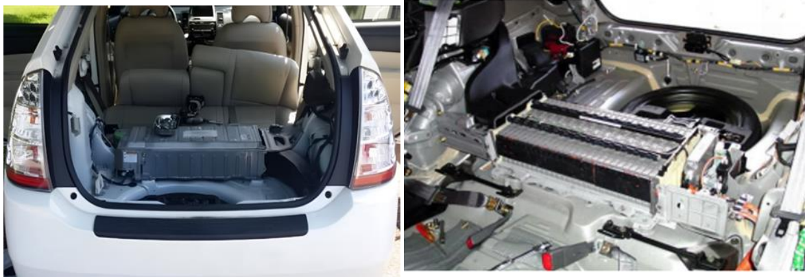
Figure 14: Emplacement de la batterie dans la Toyota Prius 2010 [12]
