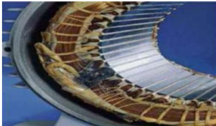
Fig 1.18: court-circuit entre spires dû aux coupures de tension [13]
