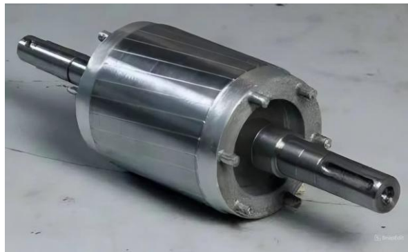
Fig 1.6: Vue schématique en perspective du rotor à cage
