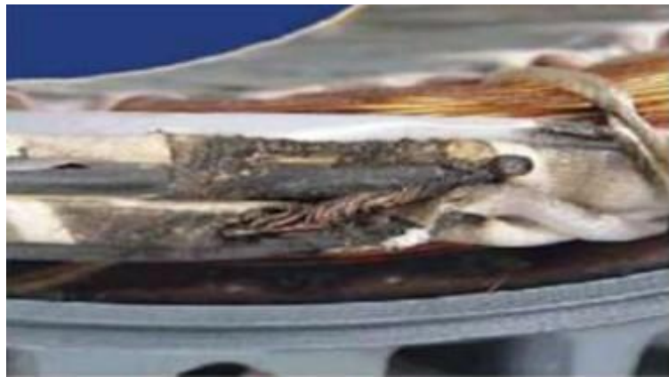
Fig 1.17: défauts d'isolant dans un enroulement [13]
