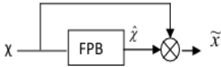
Figure II-5 a: Filtre passe haut
