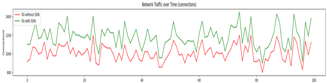
Figure3.7: Le trafic réseau( Network traffic) du 5G avec SDN et sans SDN.
