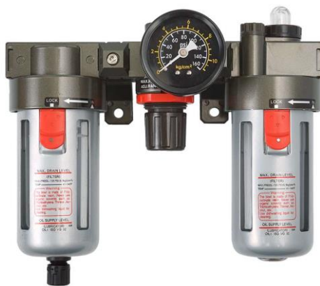
Figure I.19:group de conditionnement. [36]
