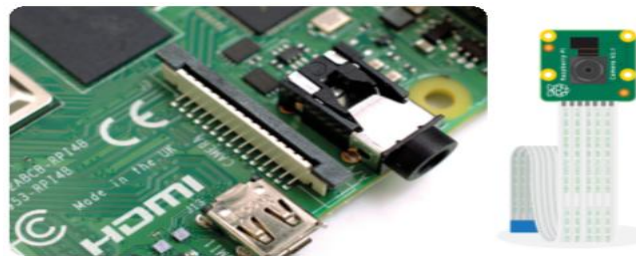
Figure II. 9 : L'entrée de la caméra CSI [37] [38].
