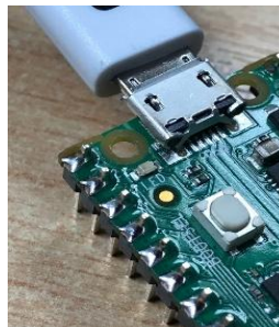
Figure II. 23 : Branchez l'extrémité petite du câble USB au Pico W [51].
