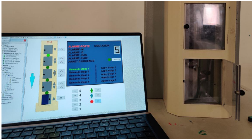
Figure IV.68. Activation de l'alarme de porte ouverte
