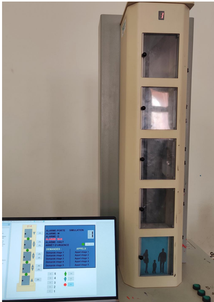
Figure IV.66. Activation de l'alarme de niveau bas
