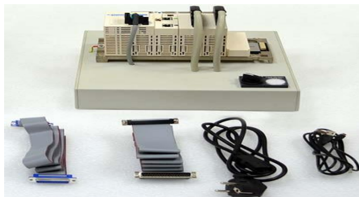
Figure III.2 La partie commande
