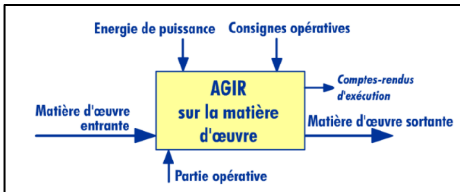
Figure II.3 Structure de la partie opérative
