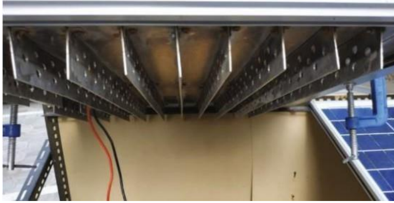
Figure I.14 : Refroidissement des panneaux utilisant des dissipateurs thermiques [26]
