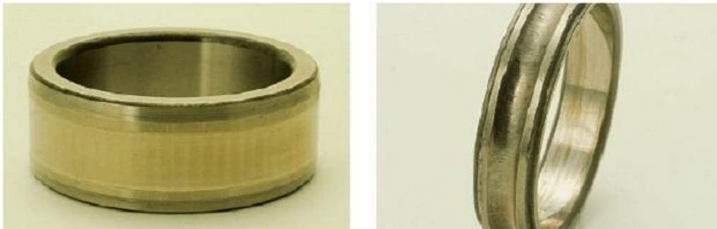
Figure II.10 : Corrosion sur une piste de roulement
