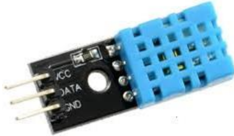
Fig 2.7: module de capteur DHT11
