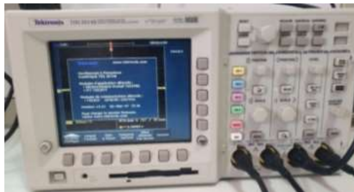
Figure IV.12 : Oscilloscope Tektronix 4 voies.
