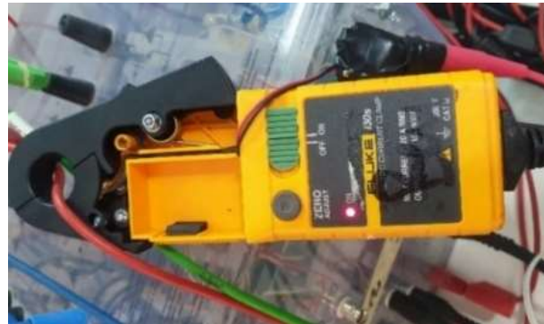
Figure IV.10 : Capteur de courant i310s-Sonde de courant.
