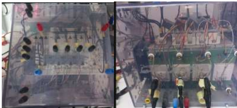
Figure IV.5 : Convertisseur de puissance à IGBT, proposé par la firme SEMIKRON.
