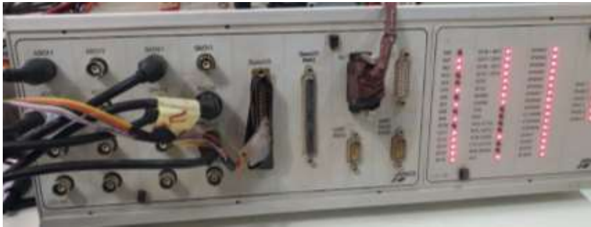
Figure IV.7 : Carte de commande DSPACE 1104.
