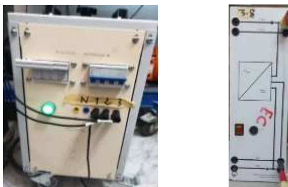
Figure IV.4 : Réseau triphasé + autotransformateur et alimentation monophasé 15V.
