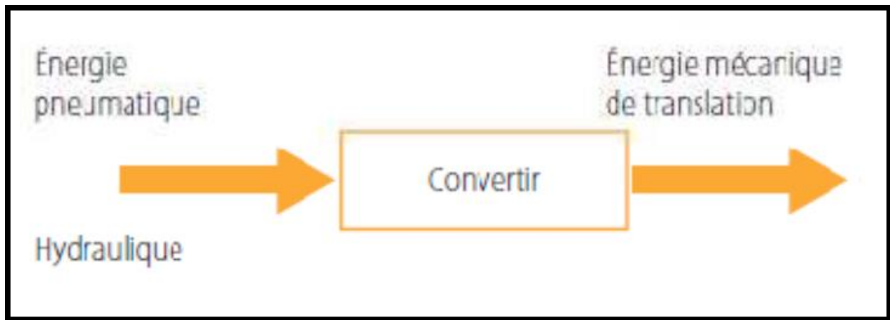
Figure II.24: Fonction de la chaîne d'énergie
