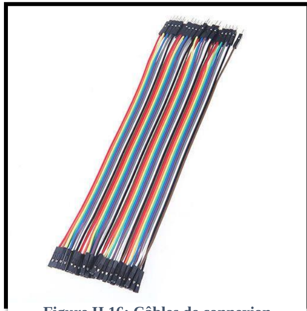
Figure II,16: Câbles de connexion
