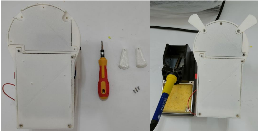
Figure IV.37. Le processus d'installation des pieds de support du robot.
