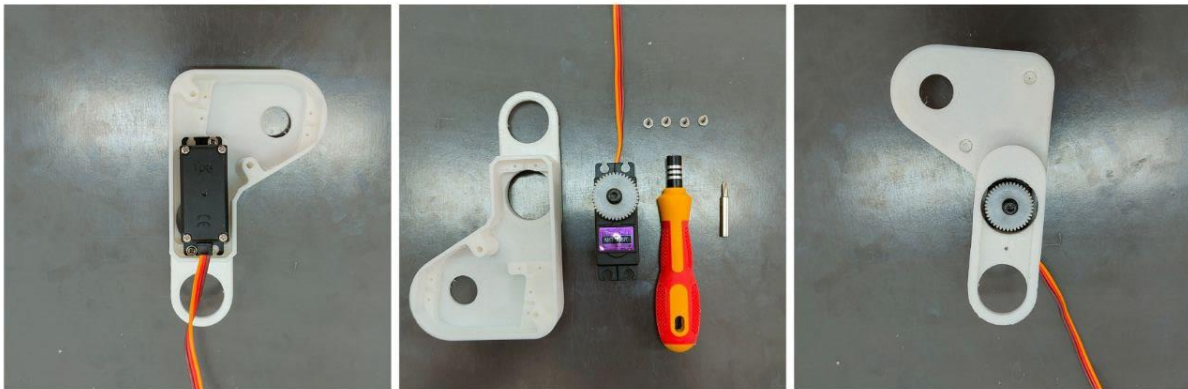
Figure IV.10. La fixation de moteur dans la pièce de robot
