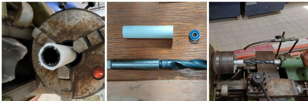
Figure IV.41. Procédé de tournage de l'axe de rotation
