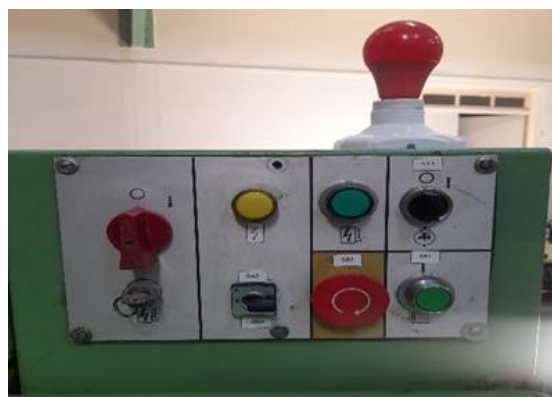
Figure III.30: Un voyant jaune indique la position 0 ou 1 de l'interrupteur général.
