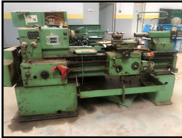
Figure III.6: L'état du tour avant la rénovation.
