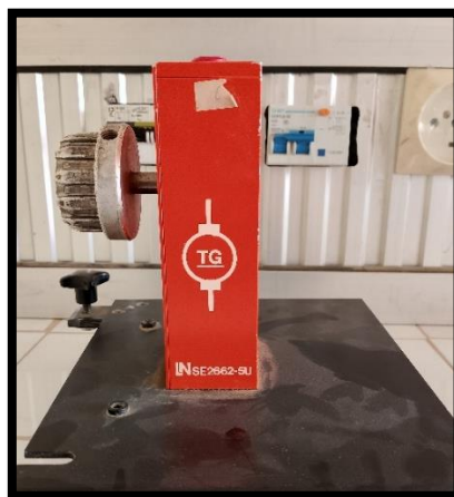
Figure III.19: Capteur de vitesse (génératrice tachymétrique).
