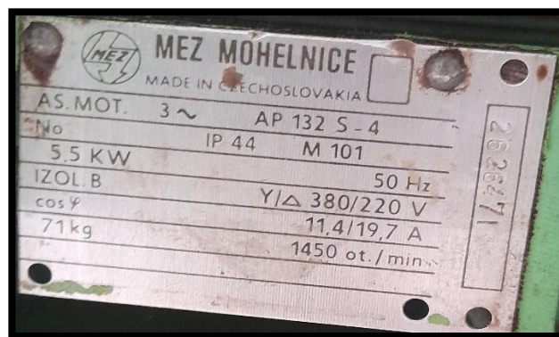
Figure III.11: La plaque signalétique de moteur M1.
