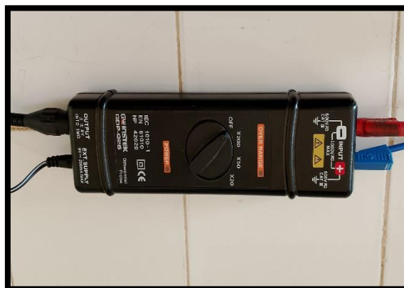
Figure III.21 :Capteur de tension:
